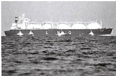
Una nave rigassificatrice riceve gas liquefatto e lo riporta allo stato gassoso
