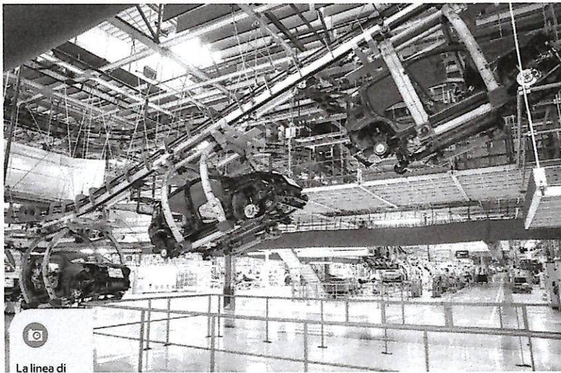
La linea di montaggio della Panda nello stabilimento di Pomigliano d'Arco
